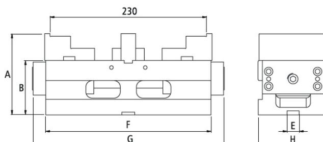
**Especificações:** Material Ferro Dútil 60 FCD, com dureza 50 HRC.
