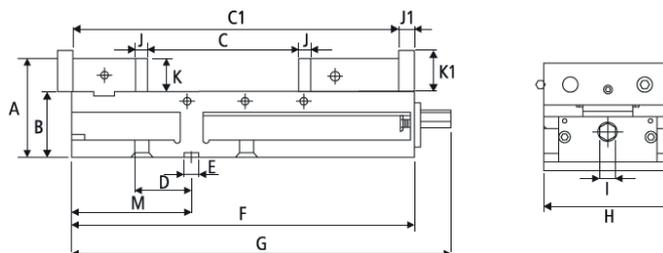
**Especificações:** Material Ferro Dúctil 60 FCD, com dureza 50 HRC.
