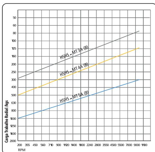
O modelo Super High Speed utiliza rolamento de contato angular de precisão combinado com rolamento de agulhas e esferas.
