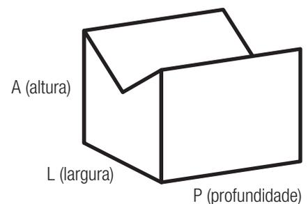
› **Importante:** Para manter tolerâncias iguais, os pares são fabricados juntos, não sendo possível formá-los com peças de conjuntos distintos
