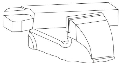
O cabo deve ser fixado numa morsa em plano inclinado para trás. Limpar cuidadosamente o encaixe do cabo, a pastilha e a lâmina com tetracloreto de carbono. Após esta limpeza, deve-se evitar contato manual nos pontos a serem soldados. Impregnar com abundância o encaixe com fluxo.
