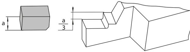
Ao confeccionar cabos para este tipo de ferramentas, a altura das paredes laterais do encaixe não deve exceder a um terço da espessura da pastilha.
